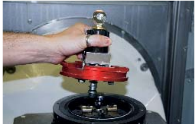
Was hier per Handbetätigung gemacht wird, macht in der Praxis der Erowa-Roboter vollautomatisch und präzise. Diese Palettisierungs-lösung ist auf 2/1000 toleriert.
