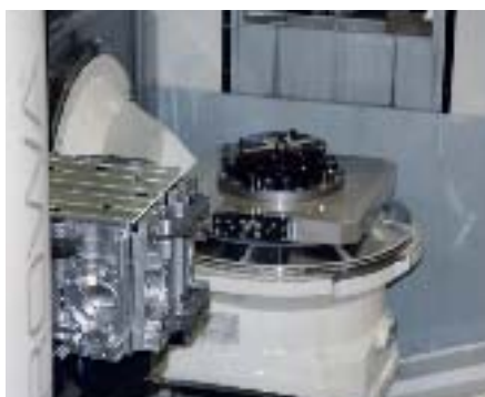
Das vollautomatische Einwechseln der Palette mit Spannturm per Roboter, der bis zu 200 kg «handeln» kann. Im ersten Bild ist sehr gut der Teller-Palettenspeicher zu sehen.
