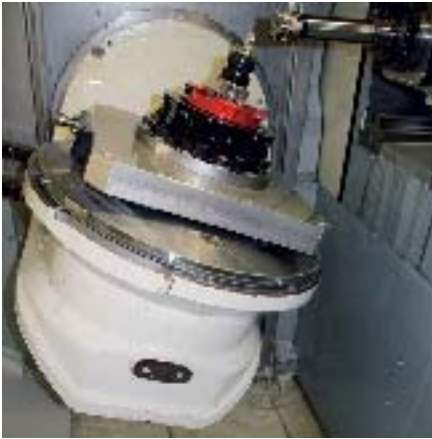
Geniales Maschinenkonzept: im linken Bild klassische Bearbeitung mit Spänefall auf Rund-Schwenktisch, im Bild rechts Überkopf-Bearbeitung mit freiem Spänefall.
