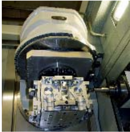
Geniales Maschinenkonzept: im linken Bild klassische Bearbeitung mit Spänefall auf Rund-Schwenktisch, im Bild rechts Überkopf-Bearbeitung mit freiem Spänefall.
