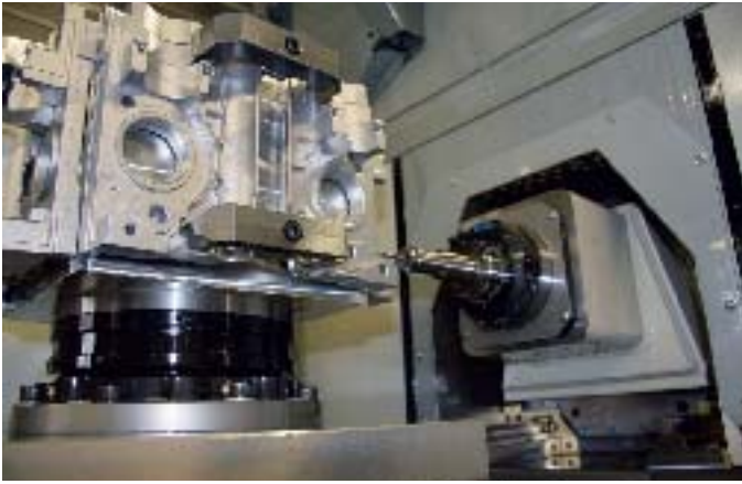
Um hohe Laufzeiten zu generieren und die Paletten optimal zu nutzen, werden die Werkstücke auf eigens gefertigte Spanntürme gespannt.
