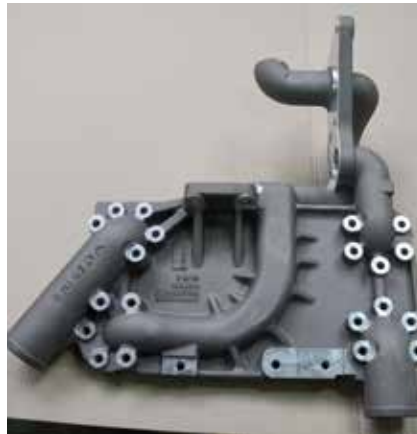
2 Mannigfaltig und nahezu beliebig komplex: zwei Beispiel-Werkstücke, die zur Fertigbearbeitung über das Flexible Fertigungssystem mit drei Grob-5-Achs-BAZ G350 laufen: Konsole (links, zwei Aufspannungen) und Pipe Air Inlet (eine Aufspannung) (Bild: Hanser)
