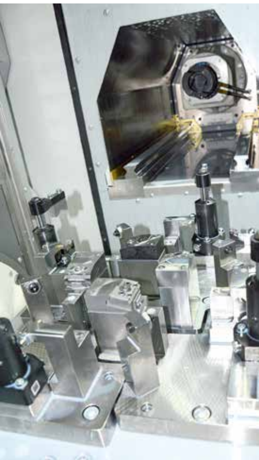
5 Arbeitsraum einer G350 von Grob: im Vordergrund auf dem Schwenk-Dreh-Tisch eine der Spannvorrichtungen, deren Grundplatte auf einem Schunk-Nullpunktspannsystem sitzt (Bild: Hanser)
