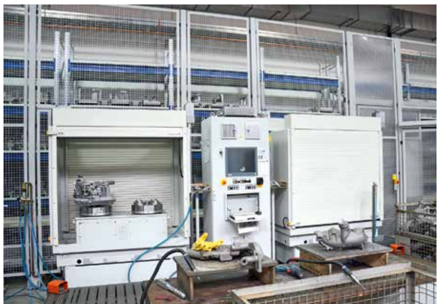
3 Zwei Doppel-Rüstplätze und der angeschlossene Palettenbahnhof mit 116 Plätzen kennzeichnen das Automationssystem LoadMaster Compact 600 von Schuler, das bei Ohm & Häner drei Grob-BAZ vom Typ G350 versorgt (Bild: Hanser)
