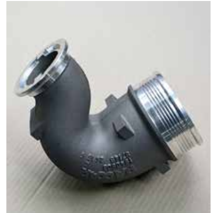
2 Mannigfaltig und nahezu beliebig komplex: zwei Beispiel-Werkstücke, die zur Fertigbearbeitung über das Flexible Fertigungssystem mit drei Grob-5-Achs-BAZ G350 laufen: Konsole (links, zwei Aufspannungen) und Pipe Air Inlet (eine Aufspannung) (Bild: Hanser)
