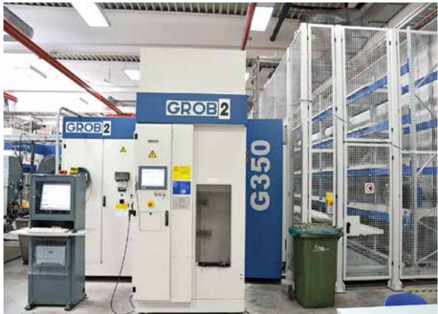
4 Blick auf das FFS bei Ohm & Häner: Das flexible Fertigungssystem wurde nachträglich von zwei auf drei 5-Achs-BAZ G350 von Grob erweitert; rechts der über die komplette Länge der Anlage verlaufende Palettenbahnhof mit 116 Plätzen (Bild: Hanser)
