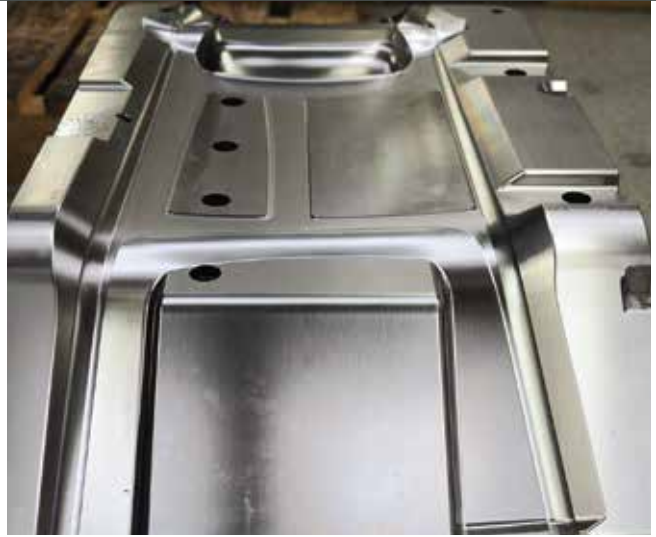
Alles gefräst: Auch feinste Oberflächen werden bei Color Metal gefräst und nicht erodiert. Mit den Bearbeitungszentren der Firma Grob bis zu Genauigkeiten von 0,01 mm. (© Hanser/Schröder)
