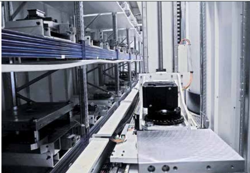
30 Speicherplätze: Ein Schuler Load Master Compact 900 bedient die Bearbeitungszentren G350 und G550 der Firma Grob. (© Hanser/Schröder)
