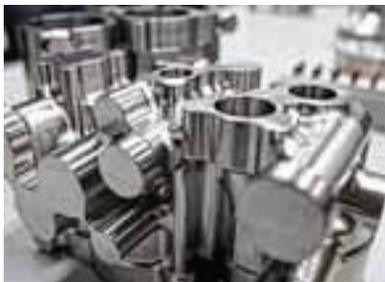
So sieht ein Hydraulikventilblock aus Titan für einen A380 aus.
