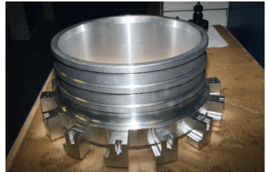
Mit 16 Zoll – mehr als 400 mm – Durchmesser lässt sich diese Schlauchkupplung dank Know-how von AWG Fittings immer noch von einer Person sicher handhaben und verriegeln.
