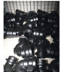
In erster Linie entstehen die Werkstücke bei AWG Fittings aus Gussrohlingen.
