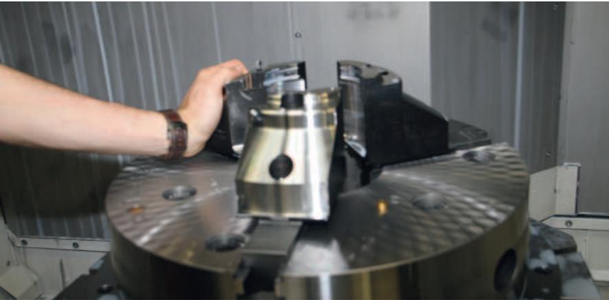
**Flexibel mit Backenfutter: Wechselbacken ermöglichen das sichere Spannen unterschiedlichster Werkstücke.**
