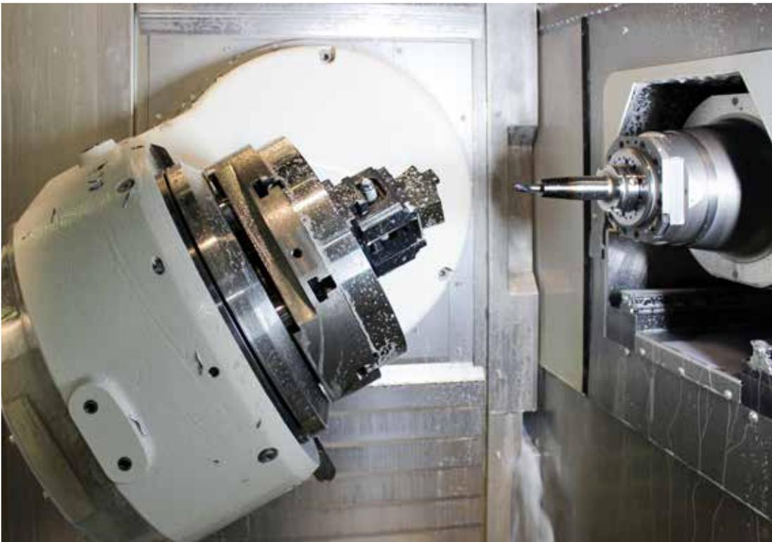
**Das Tunnel-Konzept** ermöglicht das größtmögliche Bauteil auch bei längsten Werkzeugen innerhalb des Arbeitsraums kollisionsfrei schwenken und bearbeiten zu können.
