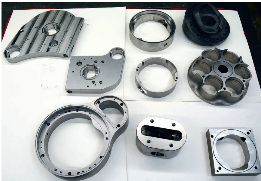
4 Kleine Auswahl in Stahl: Ein Teil des Bauteilesortiments, das Frey auf seinem Grob-5-Achs-BAZ G550 mit Palettenautomation fertigt © Hanser
