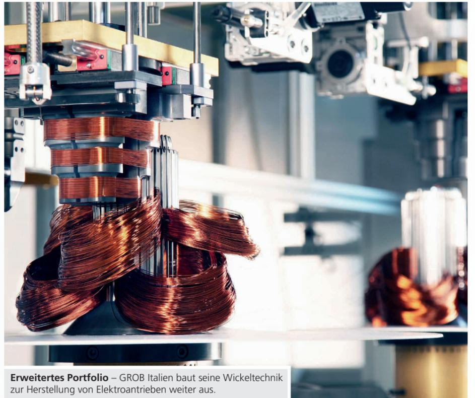
Erweitertes Portfolio – GROB Italien baut seine Wickeltechnik zur Herstellung von Elektroantrieben weiter aus.
