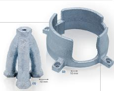
(1) 180 Hz Druckfrequenz; 590 μm Tropfendurchmesser; 115 min Bauzeit (2) 150 Hz Druckfrequenz; 685 μm Tropfendurchmesser; 160 min Bauzeit
